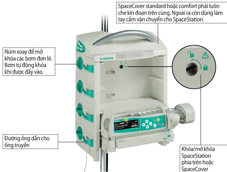
**⚠ Chú ý:** Mọi SpaceStation hoặc một cột bao gồm nhiều SpaceStations phải có nắp đậy SpaceCover standard hoặc comfort. SpaceCover bảo vệ các kết nối phía trên khỏi độ ẩm và hư hại và đảm bảo hệ thống chức năng hoàn hảo. SpaceStation và từng bơm được kết nối với nhau qua các đầu nối F2A tới F2D. Các phích cắm cần được bảo vệ khỏi hư hại và độ ẩm
