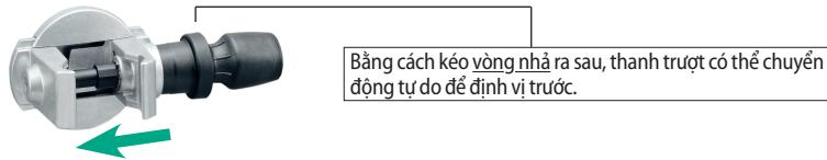
Để tháo, đầu tiên nới lỏng kẹp bằng cách xoay núm điều chỉnh một nửa đường và sau đó kéo vòng nhả ra để nới lỏng kẹp cột bằng cách sử dụng cơ chế nắm nhanh.
