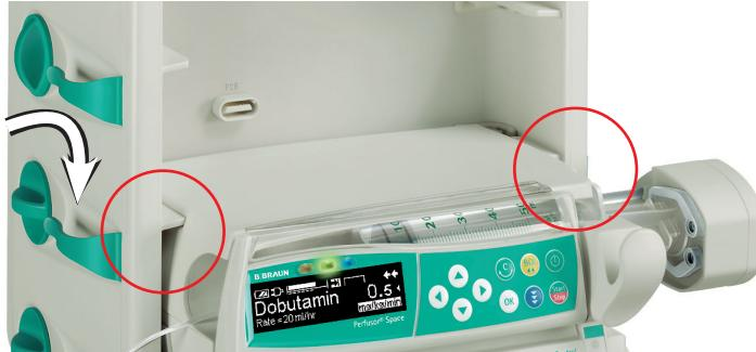
Để tháo, xoay núm theo chiều kim đồng hồ ở vị trí đứng và tháo bơm. Sau khi tháo, bơm được giữ trong SpaceStation bằng ray dẫn hướng, nhưng có thể rơi ra dễ dàng do rung động mạnh hoặc trong khi di chuyển.
