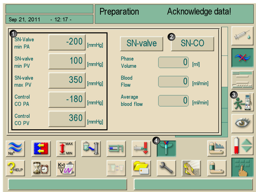
Hình 9-2 Thủ thuật một kim single-needle cross-over (SN-CO)
