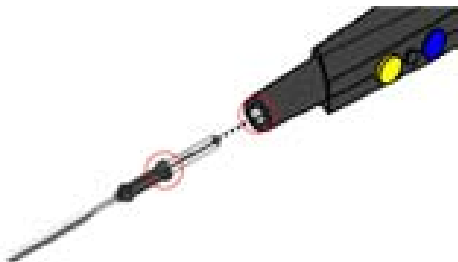
Hình 5. Lắp điện cực làm việc vào tay cầm
