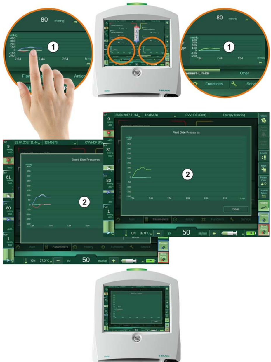
3-42 Phóng to biểu đồ trên màn hình Pressures Limits (Giới hạn áp lực)
